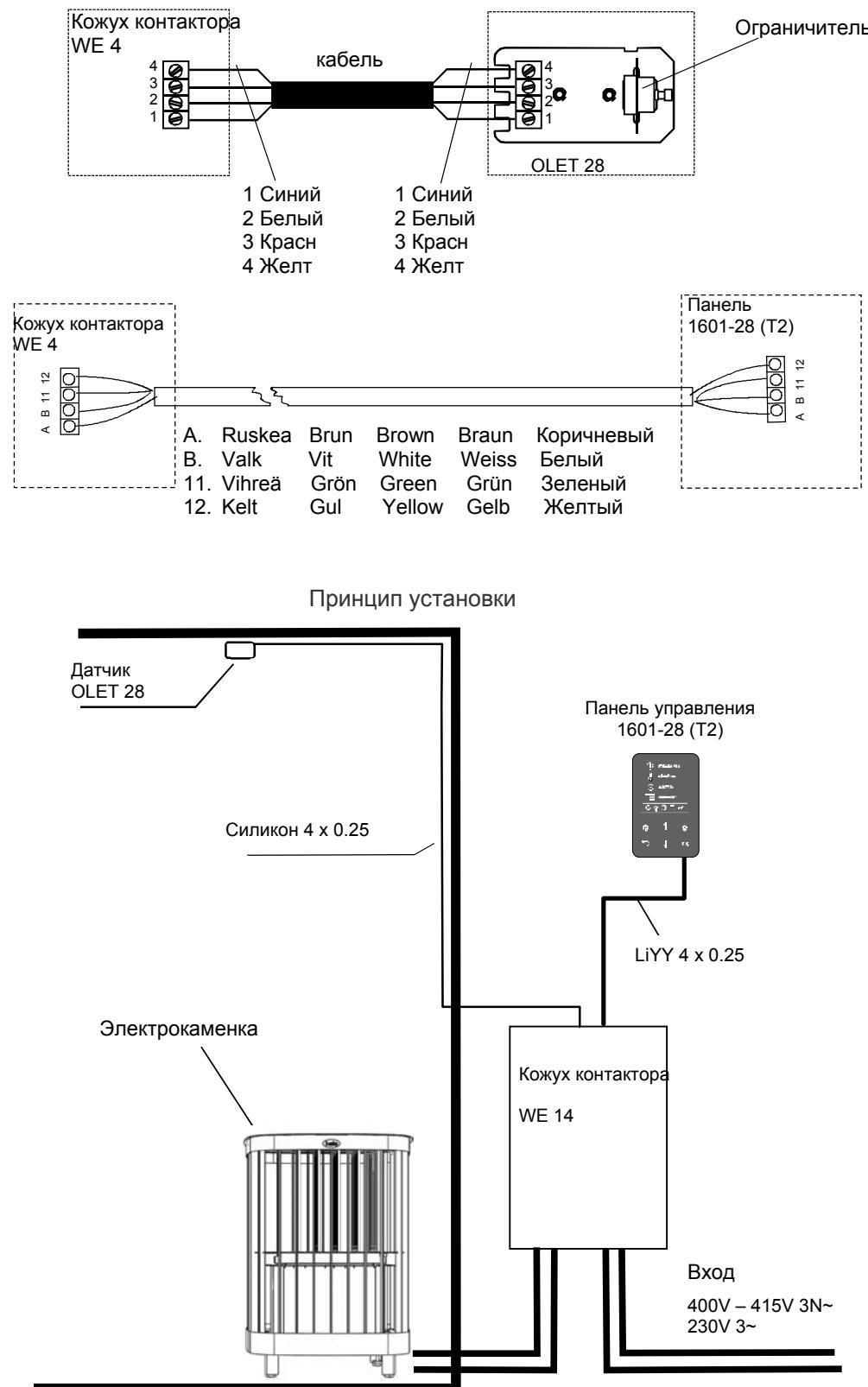
Рис. 8 Принципиальная схема соединений
