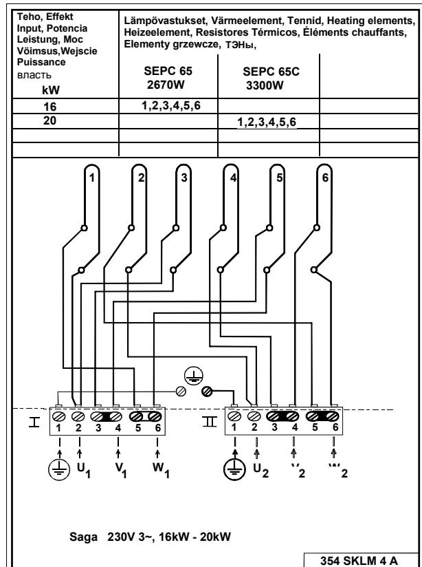
Рис. 5. 2 группы мощности 230V 3~ макс 16 кВт - 20 кВт
