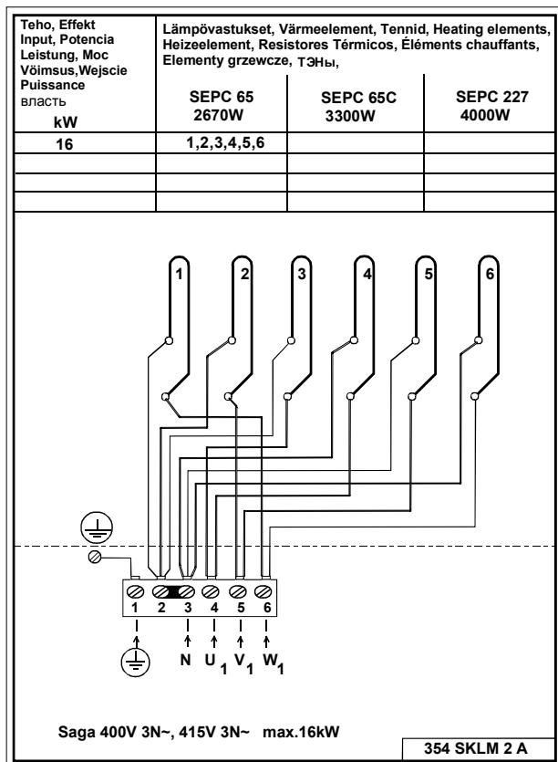
Рис. 3. 1 группы мощности 400V-415V 3N~ макс 16 кВт
