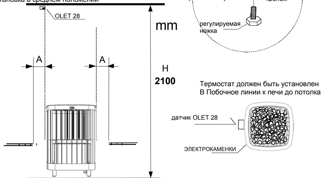
Термостат должен быть установлен В Побочное линии к печи до потолка
