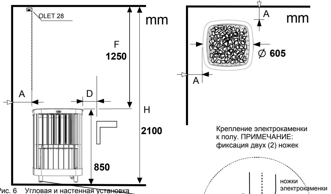
Рис. 6 Угловая и настенная установка
